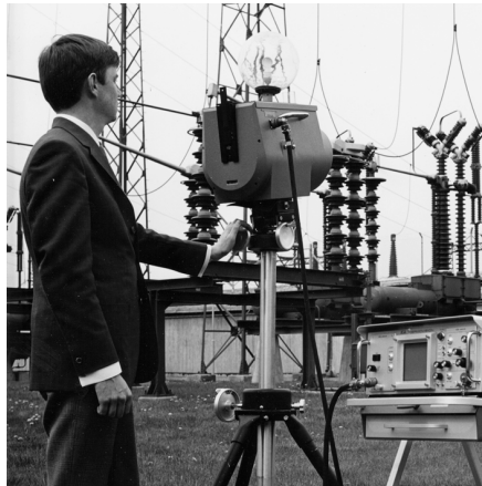
Figura 20.2 1969: Thermovision modelo 661 de 1969. La cámara pesaba unos 25 kg, el osciloscopio 20 kg y el trípode 15 kg. El usuario también necesitaba un generador de 220 V CA y un recipiente de 10 litros con nitrógeno líquido. A la izquierda del osciloscopio se puede observar el accesorio Polaroid (6 kg).
